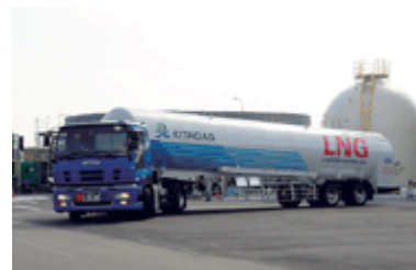
自社ローリーによるLNGサテライト供給
