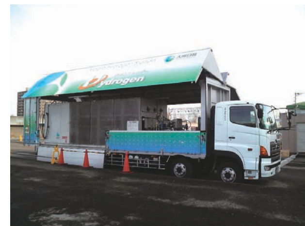
北ガスの構内に設置された移動式水素充填装置
