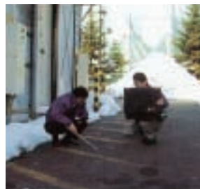
融雪路面の温度分析解析（左：融雪状況 右：同上サーモグラフィデータ）
