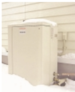
ガスエンジン発電ユニットの寒地テスト
