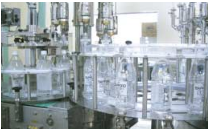
↑サブポロソフト4Lの大きなペットボトルへ瓶詰め、ラベル貼り、キャップづけが自動でされる。最後に目視で品質を確認してダンボールに詰めたら出荷。
