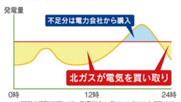
※暖房の運転状況により、発電出力1.5kW・1.2kW・0.75kWのいずれかで定格運転します。
