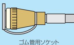
ガス機器、接続具およびガス栓に、ごみなどの異物がないことを確認して、確実に接続してください。
