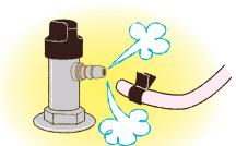
●30日間連続してガスが流れている場合には、表示ランプ(赤)の点滅で警報を発します。
