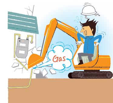
⚠ 解体工事等の前にはガス管を撤去する。
