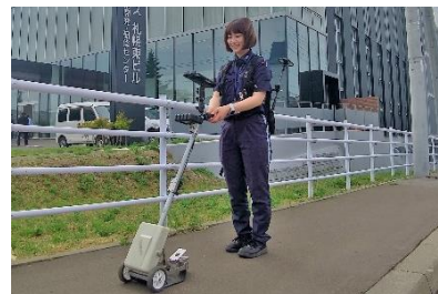
▲高精度GNSS位置情報サービスを 活用したガス導管検査管理システム
