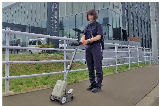
GNSS位置情報サービスを活用したガス導管検査管理システム 高効率かつ正確な導管検査
