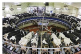
搾乳設備（ロータリーパーラー）
