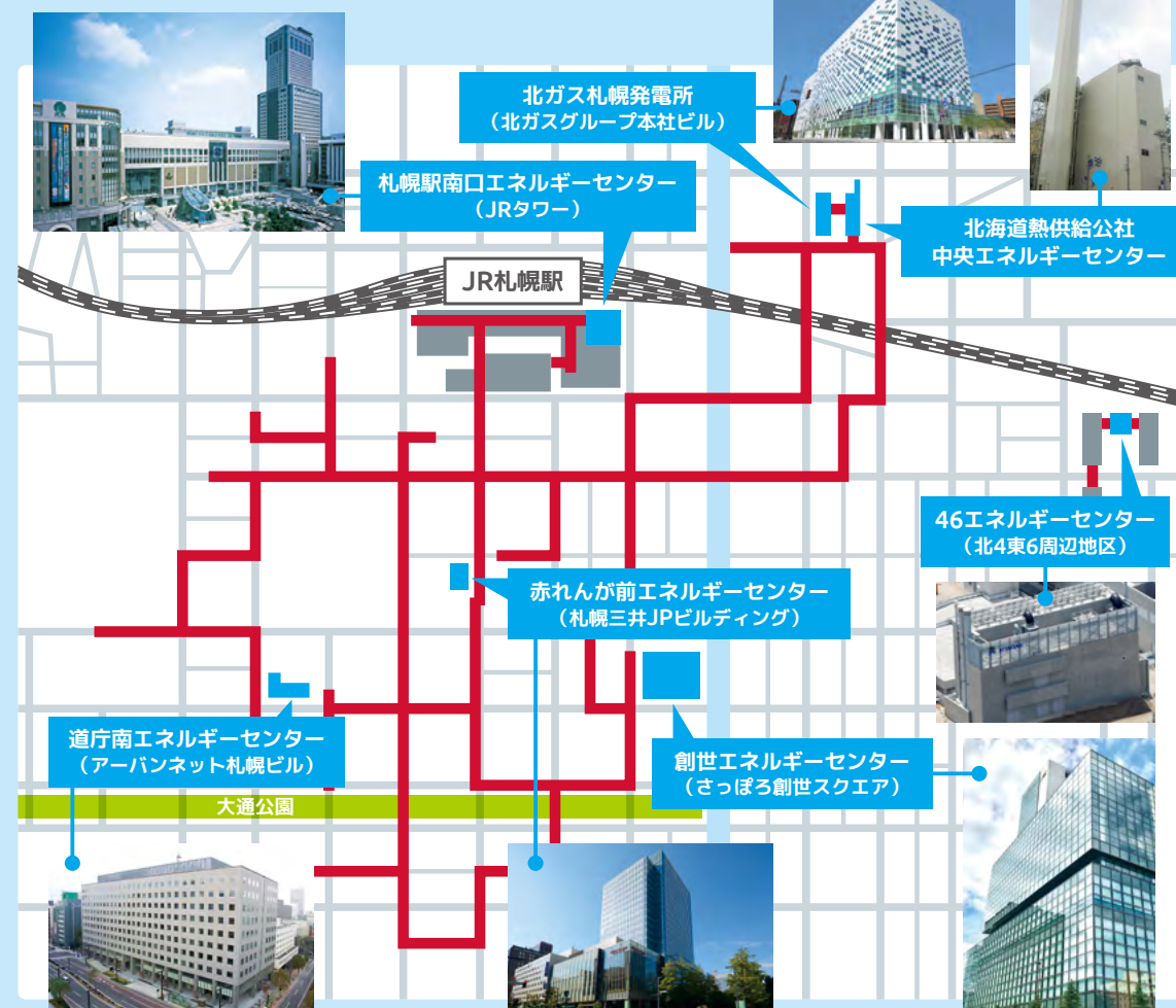
札幌都心部の地域熱供給ネットワーク ー 熱導管
